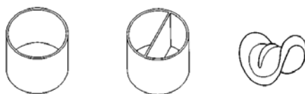
Слика 2 Основне врсте испуне а - Рашигови прстен, б - Лесингов прстен, в – Берлова седла
